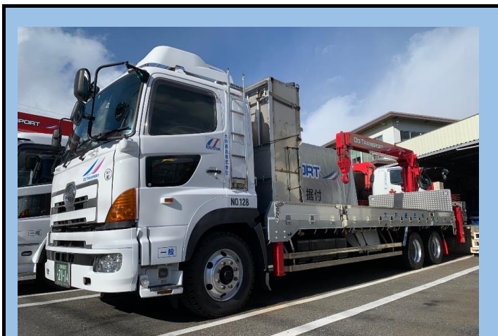
10t中低床エアサス後部架装ユニック車(4.9t吊り)
