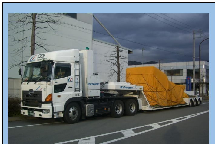
中落低床エアサストレーラ(35t積載・荷台長6,800mm、荷台高450mm)・舵切りステアリング機構付き
