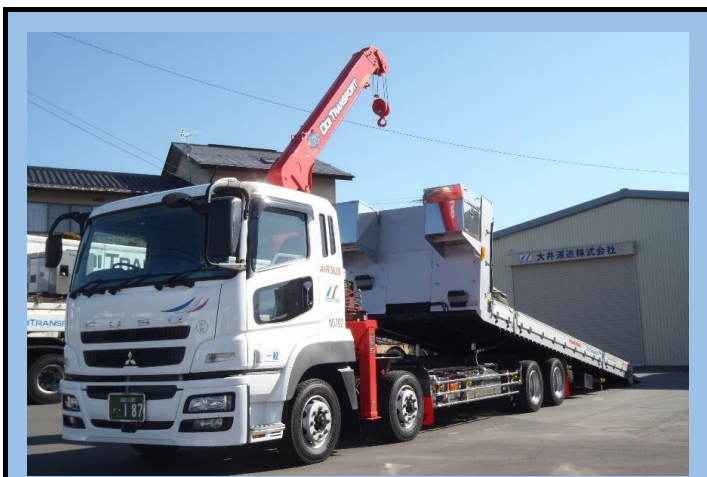
10t低床エアサスセーフティローダーユニック車(2.95t吊り)
