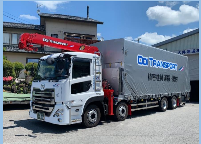
10t低床エアサスアコーディオンホロユニック車(2.95t吊り)
