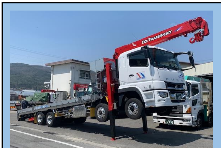
10t低床エアサスセルフユニック車(4.9t吊り)
