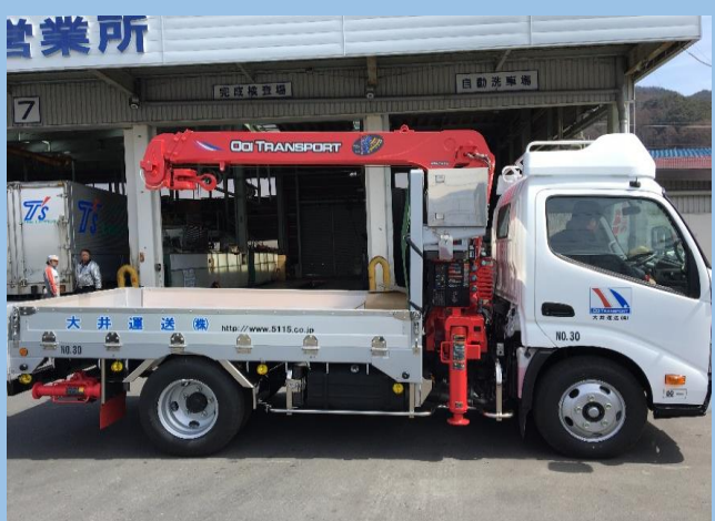
3tユニック車(2.35t吊り)
