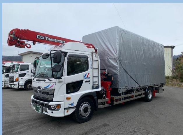
7tエアサスアコーディオンホロユニック車(2.93t吊り)
