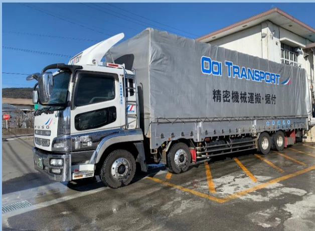
10t低床エアサスアコーディオンホロ車・2.5tパワーゲート付き
