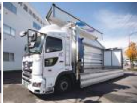
上部からの吊り上げが可能なオーバーターンウイング仕様
