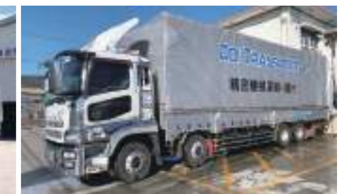
10t低床エアサスアコーディオンホロパワーゲート車
