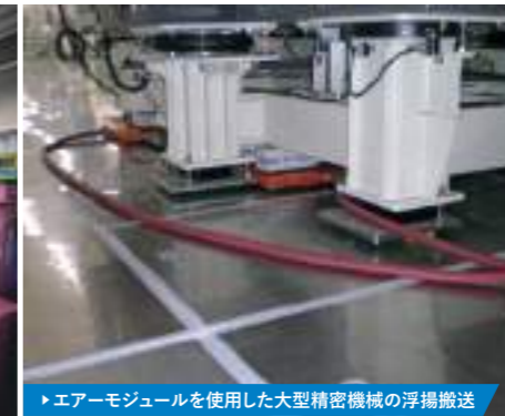
▶エアモジュールを使用した大型精密機械の浮揚搬送
