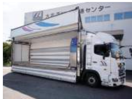
フォークリフト作業が可能な特殊ウイング(室内高2705mm)
